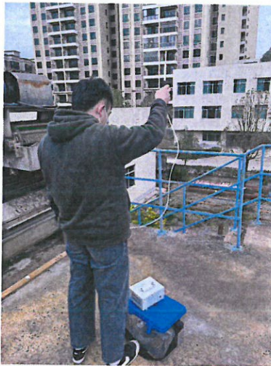
厂区内甲烷检测点 (进水口旁)
